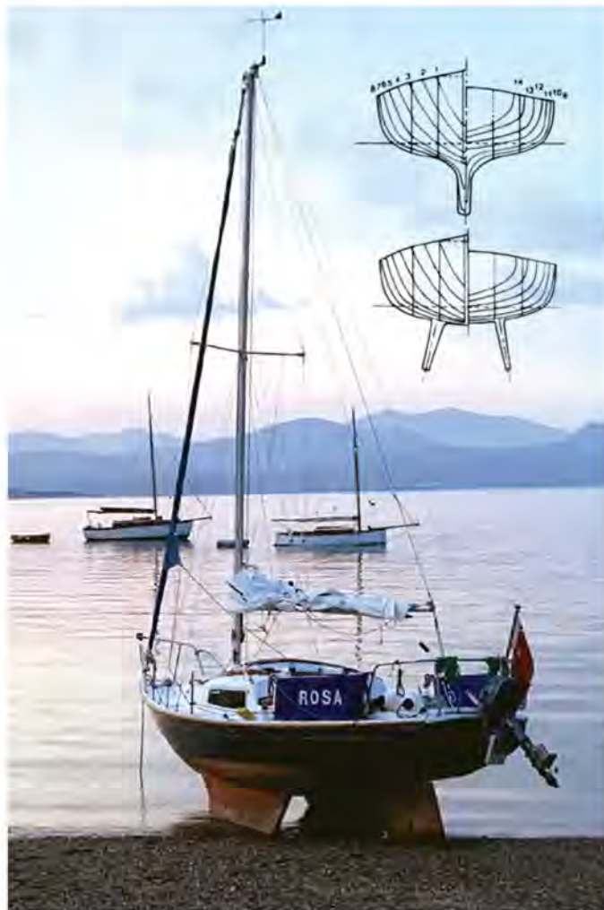
Яхта Corribee Mk II выпускалась и со скуловыми килями
