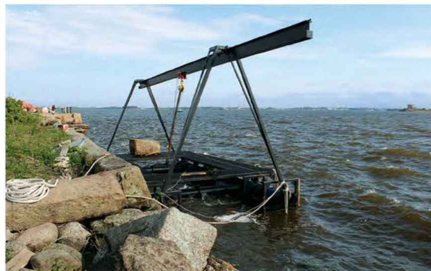
Понтон, построенный специально для подъема со дна Финского залива гранитных блоков набережной форта Граф Милютин, 2018 г. Фото С. А. Соколова
